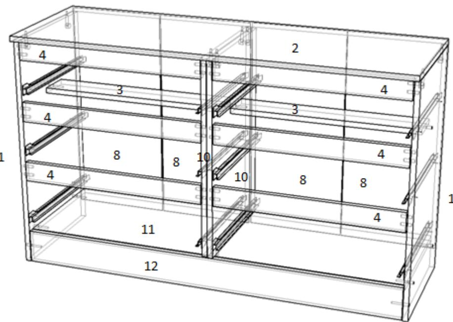
К детали 1 и 10 привернуть направляющие колесиком вперед. Прибить гвоздями подпятник к детали 1. В готовые отверстия деталей 1 и 10 вставить шкант 8\*30. Евровинтами скрепить детали 1, 3, 10, 11 и 12 предварительно установить планку 4 на шканты. Ввернуть шток эксцентрика в деталь 2 и скрепить крышку с боковинами 1 и 10 замком эксцентрика.
