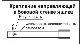
Схема В Установка направляющих шариковых
