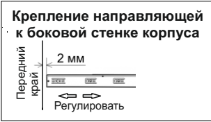
Схема В Установка направляющих шариковых
