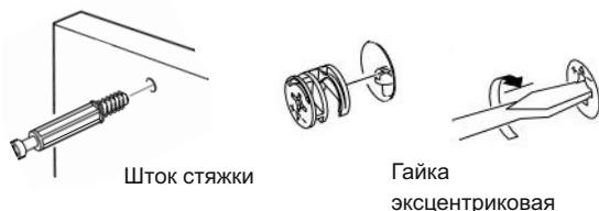
Схема А. Установка стяжки эксцентриковой
